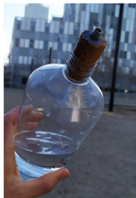
L'ampolla amb el tap de suro i la rosca metàl·lica per enganxar la vàlvula de la bomba
